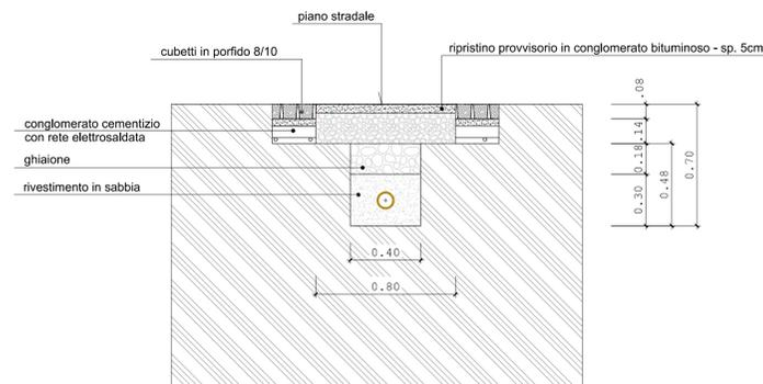
**SEZIONE TIPO DI SCAVO SU PAVIMENTAZIONI IN PORFIDO - COLTURA**
