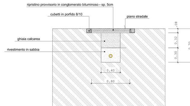
**SEZIONE TIPO DI SCAVO SU PAVIMENTAZIONI IN PORFIDO - PEZ**
